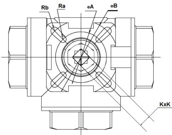
Габаритные размеры, вес и Kv (таблица) кранов шаровых нержавеющих из стали AISI316 (CF8M) Ду 8-50 Ру40 резьба/резьба.
