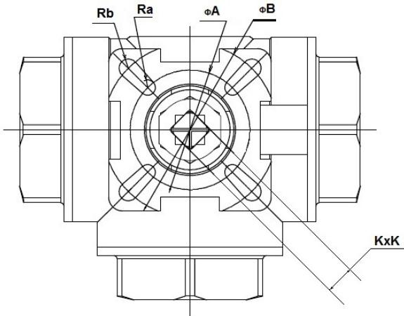
Чертеж габаритный шарового крана ABRA-BV15 L-порт
