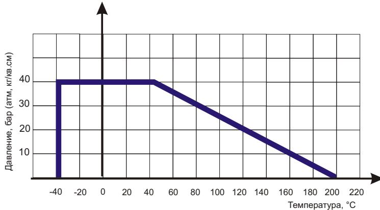
Диаграмма определяет рабочую область для шарового крана ABRA-BV15 в координатах Давление (в барах приборного) / Температура (° С).
